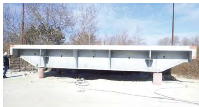
Obr. 6 NDT kontrola – meranie hrúbky káblového žlabu st. Čunovo a kontrola provízorého hradenia TG 6 VEG 2022
