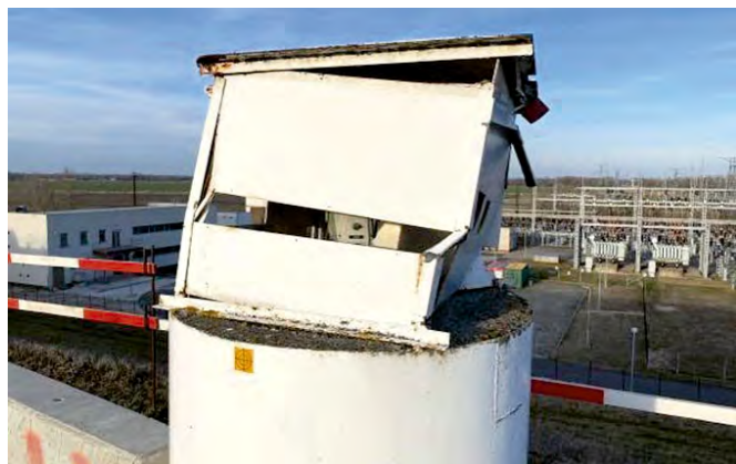
Obr. 8 Poškodené stanovisko tachymetra pri ľavej plavebnej komore VDG, ktorý je súčasťou systému GeoMonitor, 2022
