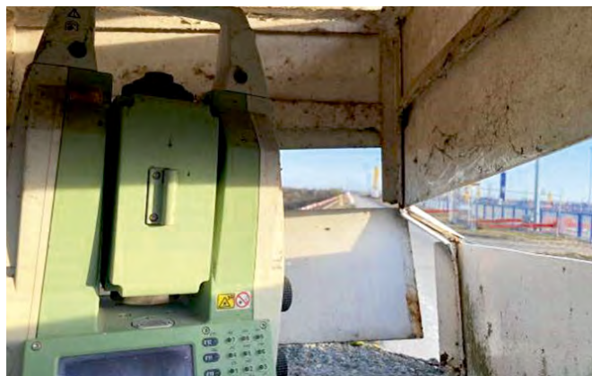
Obr. 8 Poškodené stanovisko tachymetra pri ľavej plavebnej komore VDG, ktorý je súčasťou systému GeoMonitor, 2022
