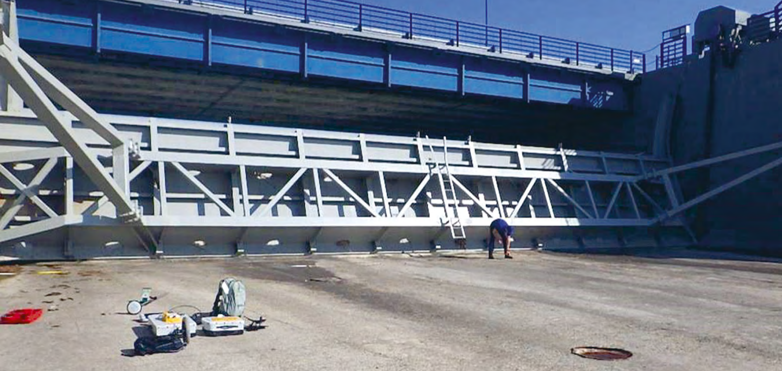
Obr. 4 Merania GPR na haľových poliach v Čunove (02. 08. 2022)
